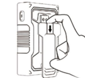
02 そのままクリップを下にス ライドして取り外します。
